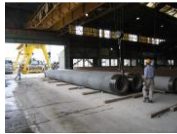
出荷を待つ大口径杭
