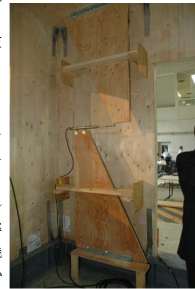
層間変形測定変位計
