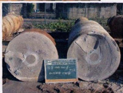
【拡大根固め球根(切断面)】
